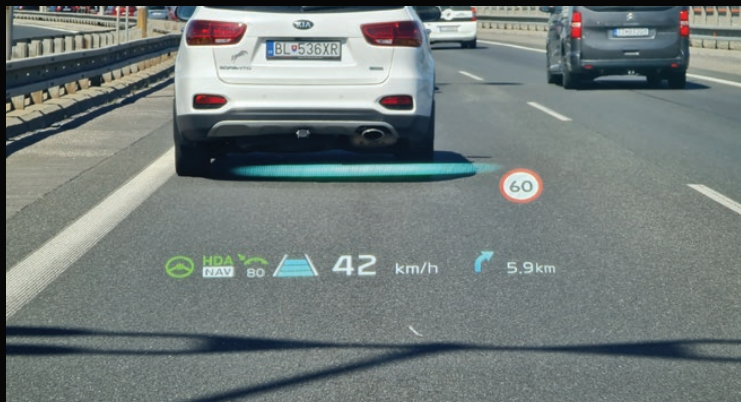
■ Head-up displeje sa stále zväčšujú a niektoré zobrazujú symboly aj v rozšírenej realite priamo na ceste. (Hore Hyundai IONIQ 5, dole BMW i7)
