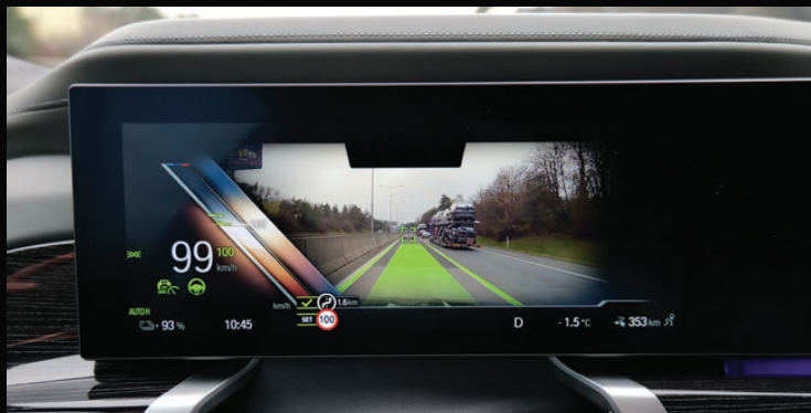
■ Prístrojový panel môže priamo v živom obraze z kamery zobrazovať v rozšírenej realite činnosť asistenčných systémov aj navigačné symboly (BMW i7)
