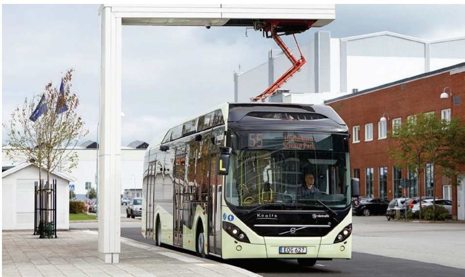
■ Pre autobusy je typický systém nabíjania cez pantograf. Takého nabíjačky možno umiestniť aj na niektoré zastávky v rámci mesta na nabíjanie počas zmeny.
