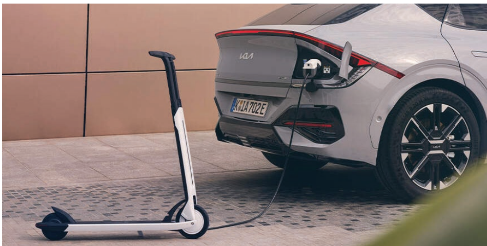
■ Externé zásuvky 230 V systému V2L alebo V2H sú typicky riešené ako redukcia do nabíjacieho konektora Typ2
