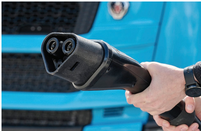
■ Megawatt Charging System využíva aj nový typ konektorov s kvapalinovým chladením na prenos vysokých nabíjacích výkonov
