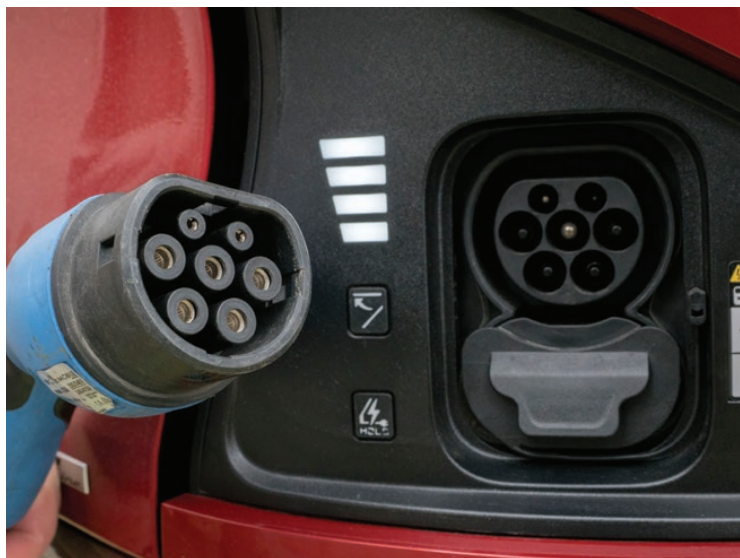
■ V domácich podmienkach sa využíva konektor Typ 2 Mennekes, ktorého zásuvka je na elektromobiloch časťou konektora CCS2
