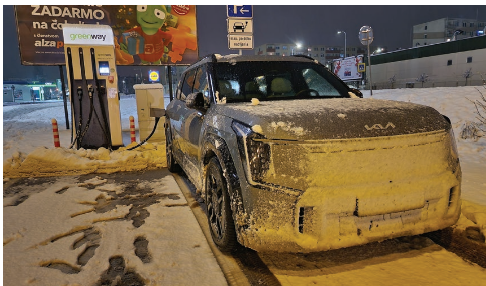
■ Silné sneženie, námraza alebo dážď môžu oslepiť radar aj kamery vozidla, takže asistenčné systémy budú dočasne vyradené z prevádzky
