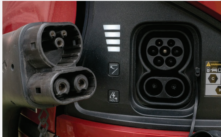
■ Na DC nabíjanie sa používa konektor CCS2
