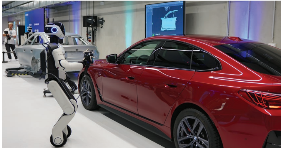
■ Jednou z činností robotov AEON v Lipsku je aj kontrola kvality pomocou skenerov
