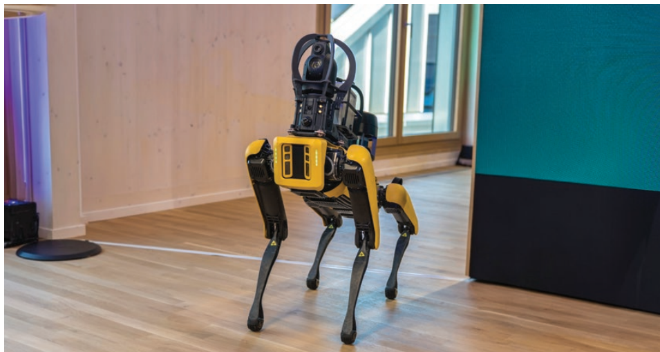
■ Robotický pes Spotto spoločnosti Boston Dynamics monitoruje bezpečnosť, úniky plynov či prehrievanie technológií.
