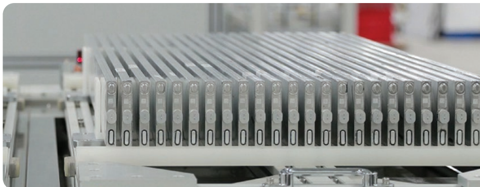
■ Konštrukcia LFP batérií s čepelovými článkami (Blade battery) umožňuje vďaka väčšej aktívnej ploche článkov s minimom pomocných materiálov dosahovať vyššiu kapacitu v pomere k objemu
