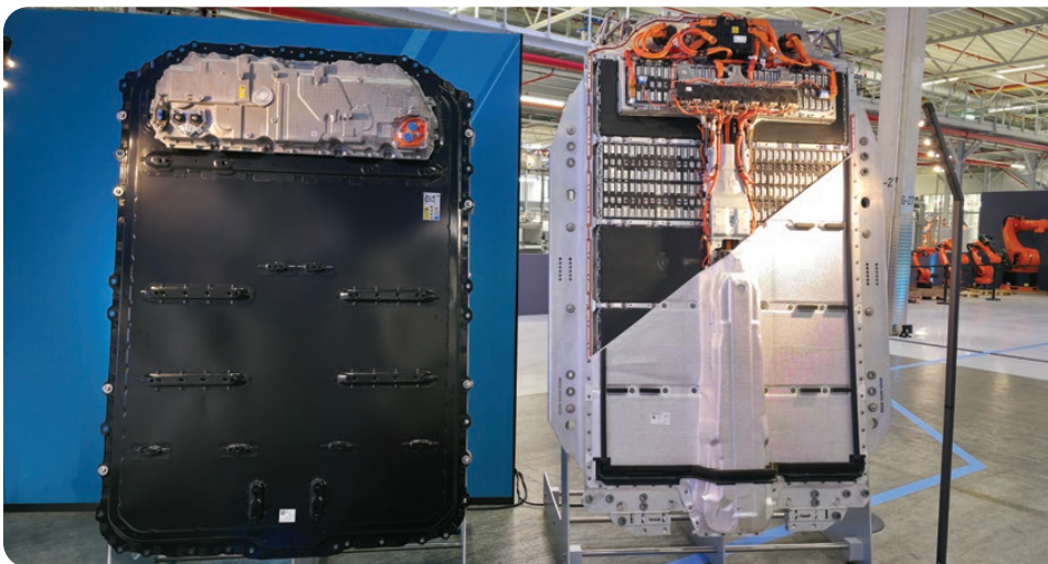
■ Porovnanie batérií BMW Gen. 6 (vľavo) s konštrukciou Cell-to-Pack a Gen. 5 s modulárnou konštrukciou
