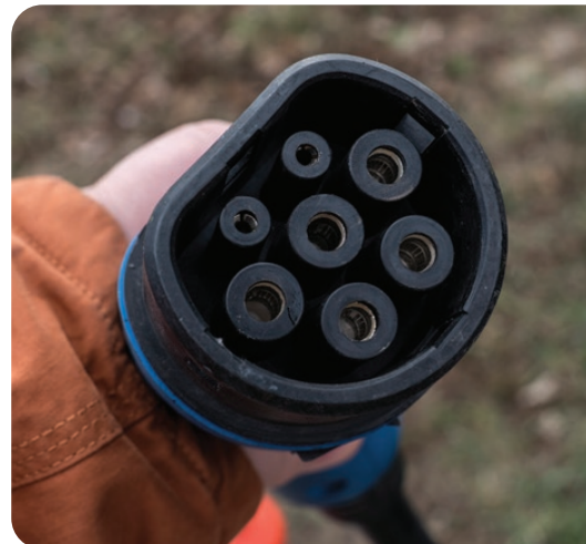
■ Konektor Typ2 Mennekes - iba pre AC nabíjanie
