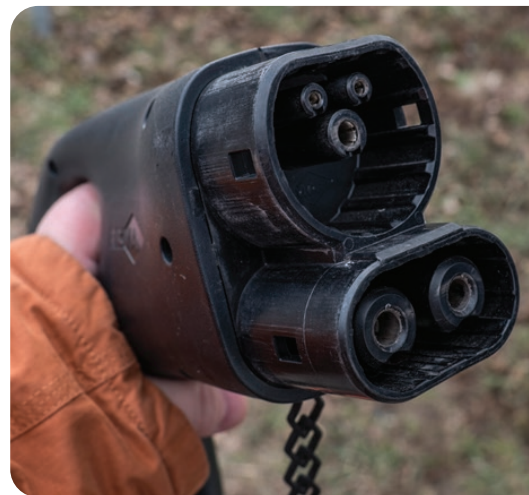
■ Konektor CCS2 - štandardný európsky konektor pre AC aj DC nabíjanie.
