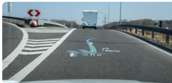
■ Nový Head-up displej s 3D zobrazením vhodne dopĺňa systém Panoramic Vision pod hranou čelného skla
