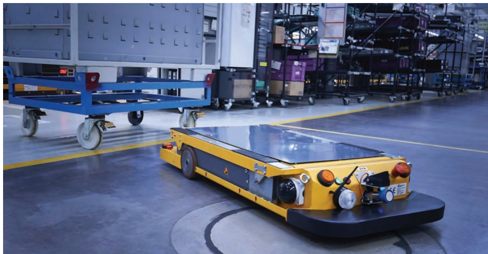
■ O prepravu materiálu vo výrobných halách sa starajú automatizované inteligentné roboty STR
