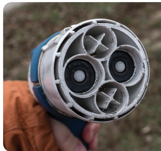
■ Konektor CHAdeMo - iba pre DC nabíjanie (v Európe už na ústupe)
